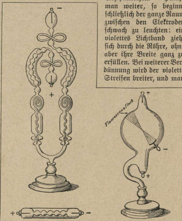
Abb. 185. Geißlersche Röhren. Zu füllen mit fluoreszierenden Flüssigkeiten. Abb. 186. Sittorfsche (Crookes'sche) Röhre.
