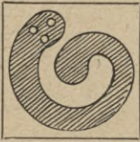
Abb. 91. Feder für den Kontaktknopf.
