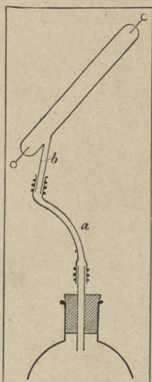
Abb. 182. Verbindung der Geißler-Röhre mit dem Rezipienten zum Auspumpen.
