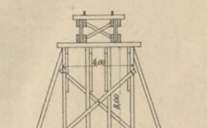
Fig. 29, 30. Kriegssprengwerkbrücke.
