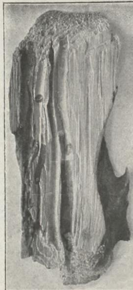
Abb. 26. Von der Oberfläche abgespaltenes Stück eines kiefernen Rundpfahls aus dem Kieler Hafen. Der vom Bohrwurm befallene Pfahl wurde 1912 gezogen.
