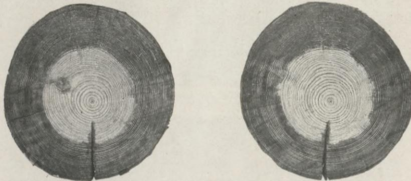
Abb. 18. Im Kessel unter Druck mit Teeröl imprägnierte Kiefer.
