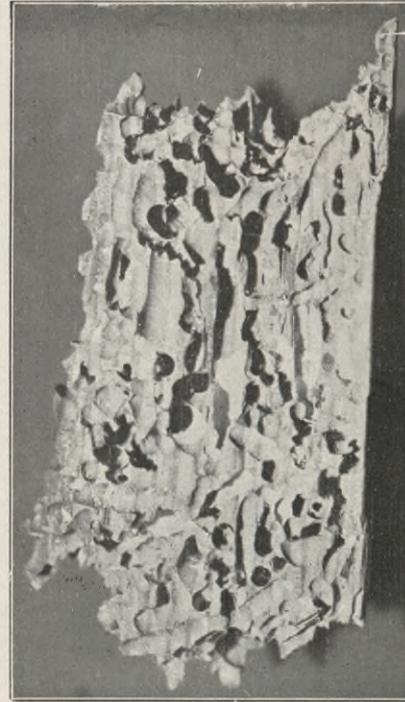
Abb. 25. Das Innere eines vom Bohrwurm befallenen kiefernen Rundpfahls aus Tsingtau.
