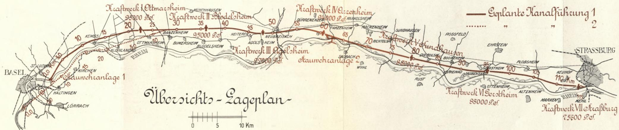
Abb. 5. Lageplan der Kanalführung.
