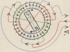
Schematische Darstellung des Drehstroms.
