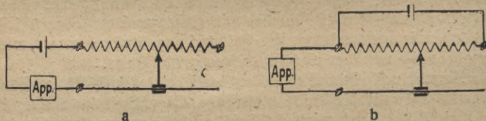
Abb. 40 a und b. Schiebewiderstände.
