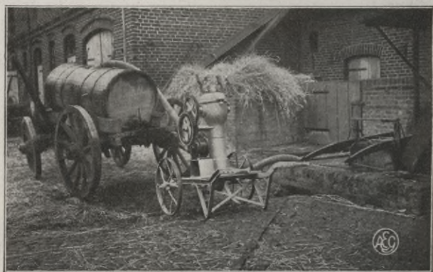
Abb. 52. Elektrisch angetriebene Tauchpumpe.
