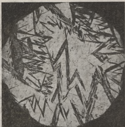
Fig. 1. Werkzeugstahl mit 1,5 Prozent Kohlenstoff. Bei 110^{\circ} in Eiswasser abgeschreckt. 350fache lineare Vergrößerung. Von E. Heyn (vgl. Materialprüfungsamt, Abt. für Metallographie).
