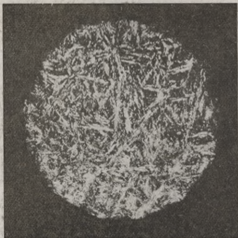
Fig. 2. Stahl mit 0,95 Prozent Kohlenstoff, bei 750^{\circ} abgeschreckt, 5 Stunden bei 275^{\circ} angelassen. 350fache lineare Vergrößerung. Von E. Heyn (vgl. Materialprüfungsamt, Abt. für Metallographie).
