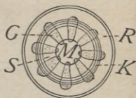
Fig. 20. Laub- und Nadelholz. Querschnitt. M = Mark, G = Gefäßbündel, K = Kambium, S = Markstrahlen, R = Rinde.
