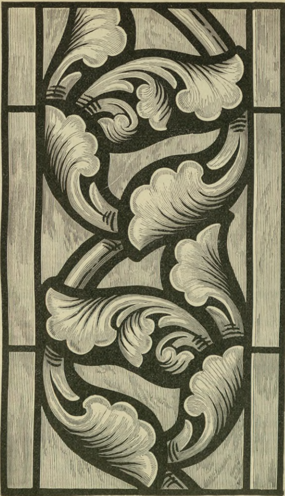
Fig. 72. Die in Kontur, Radierung und Verbleiung fertige romanische Bordüre. Siehe Fig. 69 und 71.
