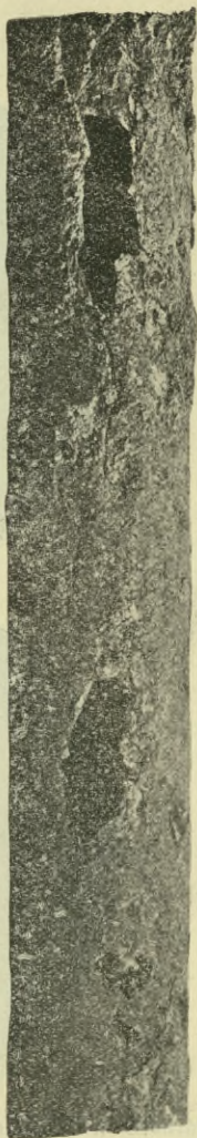
Fig. 29. Eisenrohr. Im Boden verrostetes Schmiedeeisen.
