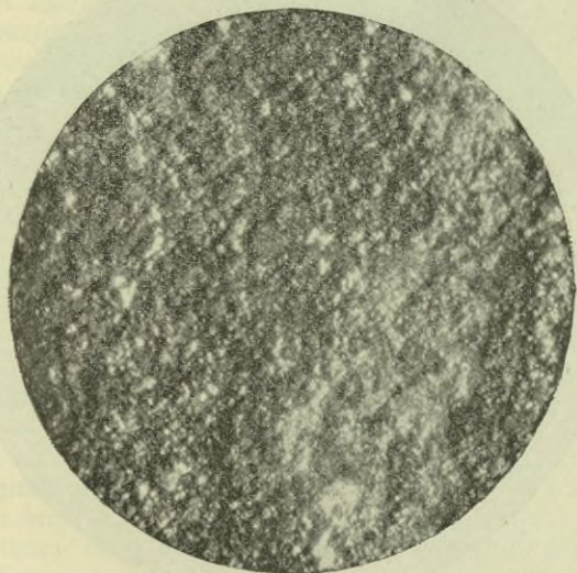
Total verrostetes Eisenblech; Einwirkung der Atmosphäre.
