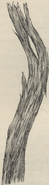
Mikroskop. Bild eines durch Säure stark angegriffenen Wollhaares.
