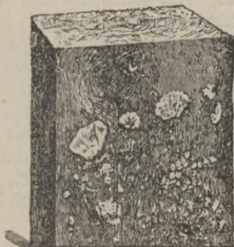
Abchnitt eines Quaiipfostens, welcher auf der im Jahre 1888 erbauten Werft des Herrn B. S. Prince in Beauvoir (Miss.) an der Golfküste mit *Avenarius Carbolineum* behandelt wurde. Derselbe war fünf Jahre hindurch, also bis zum Jahre 1893, allen Zerstörungen ausgesetzt, ohne irgendwie durch Insekten oder Fäulniß nothgelitten zu haben.
