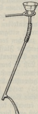
Fig. 36. Rückstoß des Wasserdrucks.
