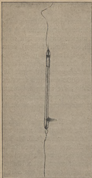
Fig. 26. Versuch von Ramsay und Soddy: Umwandlung der Emanation in Helium in der Geißlerschen Röhre.
