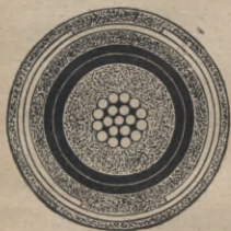
Abb. 83. Querschnitt eines einadrigen Bleikabels.
