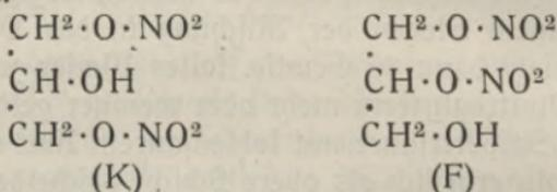
Beide isomere Körper entstehen bei der beschriebenen Nitrierung des Glyzerins. Man kann sie voneinander trennen, indem man das rohe Dinitroglyzerin, welches 3 Proz. Wasser erhält, mit Kieselgur vermischt und Temperaturen von 0° bis — 20° aussetzt. Es tritt dann Kristallisation ein. Bringt man nun einen solchen Kristall in Dinitroglyzerin, so kristallisiert ein großer Teil aus (K), von welchem der flüssig gebliebene Anteil (F) durch Absaugen getrennt wird.
