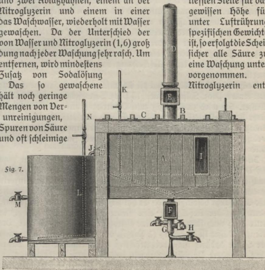
Stoffe, zum Teil von der Soda herrührend. Es wird nochmals in Gefäßen mit wirksamen Rührvorrichtungen gewaschen und sodann filtriert. Als Filtermaterial dient Flanell oder Schwamm oder auch Kochsalz, welches das vorhandene Wasser absorbiert. Die Apparatechnik hat eine Anzahl von geeigneten Filtriervorrichtungen geschaffen.
