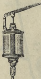
Fig. 109. Hebelpumpe zur Schmierung der Nockenwelle.
