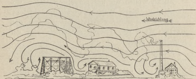
Fig. 62. Die Rauchfahne des Schornsteins zeigt die Unruhe der Luft in der Nähe der Gebäude.
