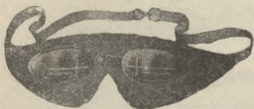
Fig. 23. Regenbrille. (Anstatt der Gläser sind Metallkapseln eingesetzt, deren eigenartig angeordnete Schlitze freien Durchblick gestatten)
