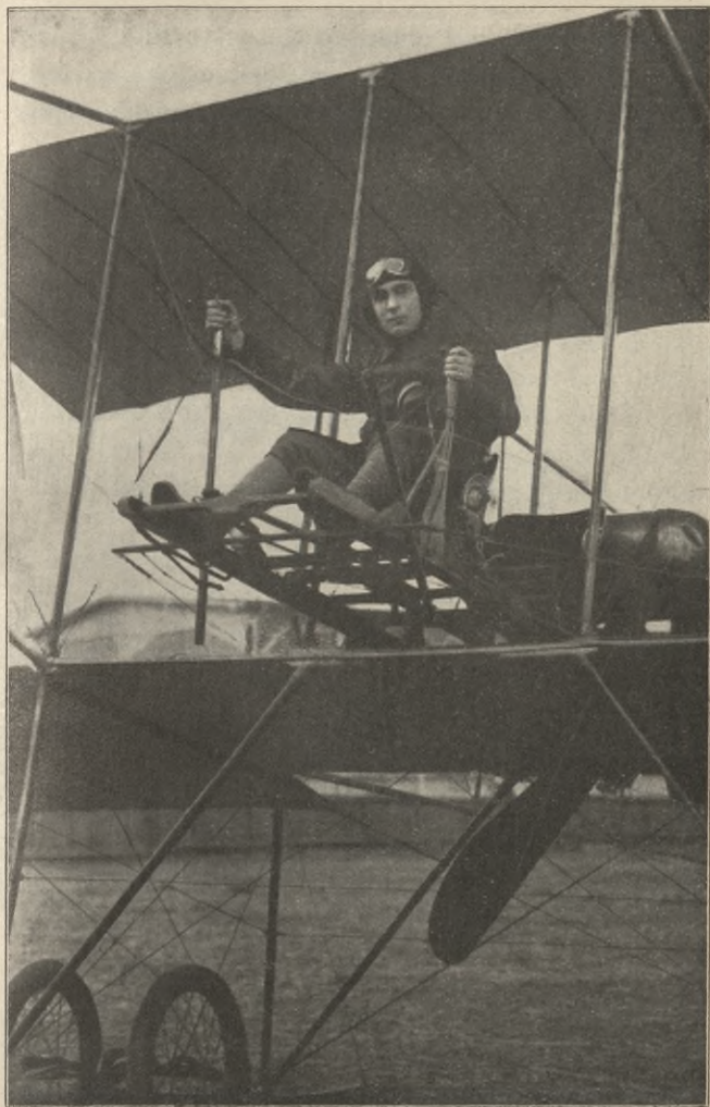
Fig. 4. Wie der Verfasser Fliegen lernte. (Alter Farman-Typ mit 70 PS Gnôme-Motor. Steuerhebel rechts.)
