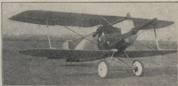
Fig. 65. D-Flugzeug der Rumpler-Werke, A.-G., oberer Flügel horizontal, unterer V-förmig angesetzt.
