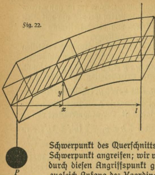
Der obere Teil des Stabes wird durch die Biegung gedehnt, der untere zusammengepreßt; eine Schicht dazwischen behält ihre ursprüngliche Länge; man nennt sie die neutrale Faser; eine in ihr liegende Linie, die vor der Biegung geradlinig war und senkrecht zur Wand stand, wird zu einer Kurve gebogen, welche die elastische Linie heißt.
