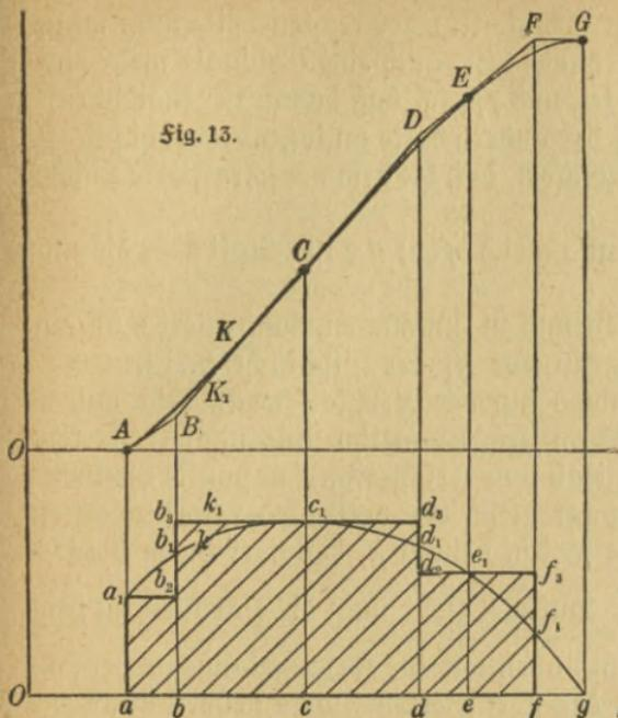
Will man  $\int_{x_1}^{x_2} f(x) dx$  berechnen, so muß man zunächst die Funktion  $F(x)$  finden, welche der Bedingung genügt, daß  $\frac{dF}{dx} = f(x)$  ist. Dann ist  $F(x_2) - F(x_1)$  das gesuchte Integral; geometrisch wird es durch die Fläche dargestellt, welche von der X Achse, der Kurve  $y = f(x)$  und den im Abstände  $x_1$  und  $x_2$  zur
