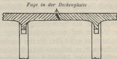
Abb. 28. Dehnungsfuge mit Mörtelabdichtung.
