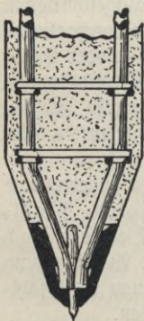
Abb. 50. Eisenbetonpfahlkonstruktion nach Züblin und Deimling.
