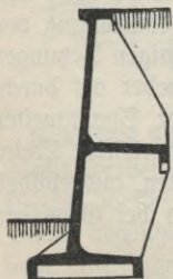
Abb. 57. Winkelstützmauer zwisch. Rippen.
