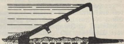
Abb. 59. Profil einer Wehr- oder Staumauer in Eisenbeton.
