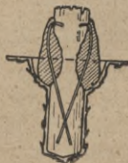
Fig. 47. Verstärkung verfaulten Holzmastensockel durch Rundeseisen und Beton. Patent der Pittsburgh Reinforcing Pole Co.
