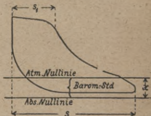
Fig. 4. Einzelzeichnung der absoluten Nulllinie in ein Indikator-diagramm.
