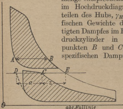
Fig. 62. Diagramm der wirklichen Zweifachexpansionsmaschine mit Zwischendampfentnahme (letzte wäre durch das Maß z dargestellt, wenn bei der Überströmung keine Verluste stattfänden).
