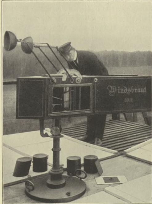
Der Winddruck-Registrierapparat auf dem alten Windenhouse.
