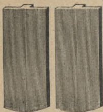
Fig. 78. Biberschwanz. doppelt, 1 m^2 = = 48 Stück = 85 kg.
