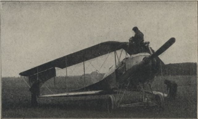
Fig. 118. Der A.-E.-G.-Zweidecker wird zusammengelegt. Flugtechnische Bibliothek, Bd. 2.
