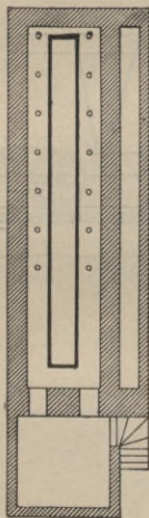
Fig. 112. Grundriß. Periodischer Muffelofen ohne Gewölbe.
