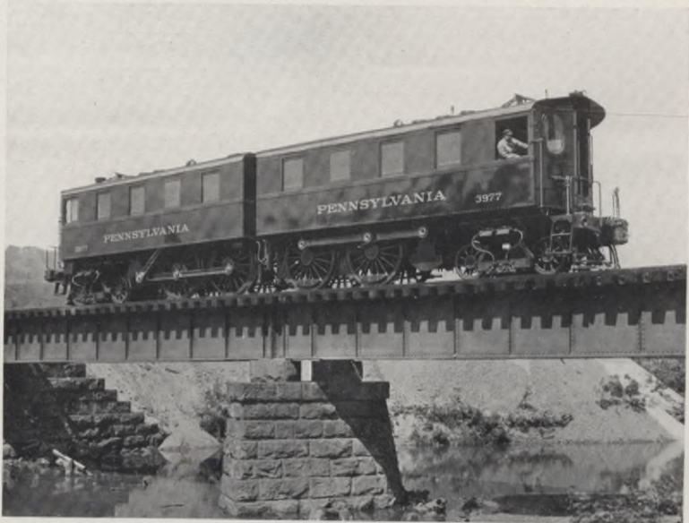
ELECTRISCHE LOKOMOTIVE VON 4000 PFERDESTAERKEN FUER DEN NEW YORKER BAHNHOF DER PENNSYLVANIA EISENBAHN. ERBAUT VON DER WESTINGHOUSE ELECTRIC AND MANUFACTURING COMPANY
