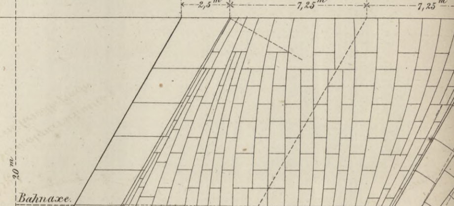
Fig. 2. Horizontalprojection des schiefen Brückengewölbes
