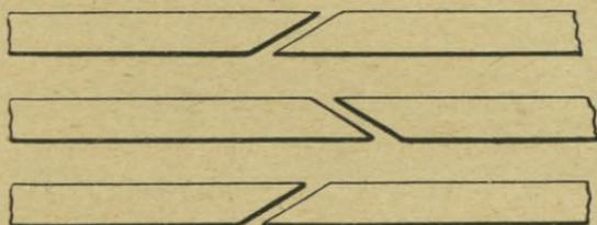
Fig. 52. Abgeschrägter Kolbenstoß.
