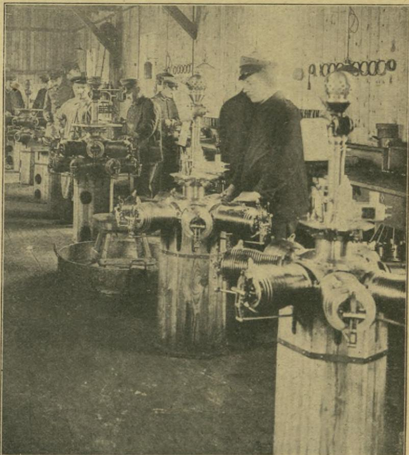
Fig. 224. Umlaufmotoren in Montageböcken.
