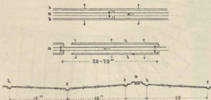
Fig. 459. Abzweigung der Wassergräben aus dem Hauptgraben.
