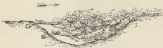
Fig. 163. Uferschutz durch Raubbäume.
