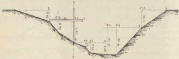
Fig. 134. Abstufung eines Querprofils.
