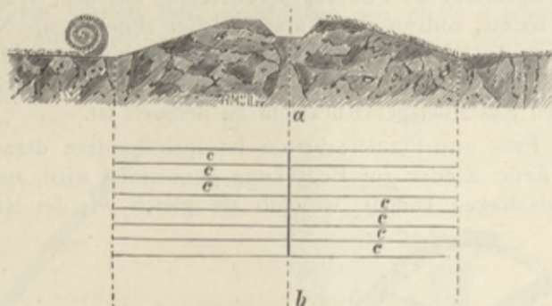
Fig. 477. Rasendeckung der Böschungen eines aufgedämmten Grabens.
