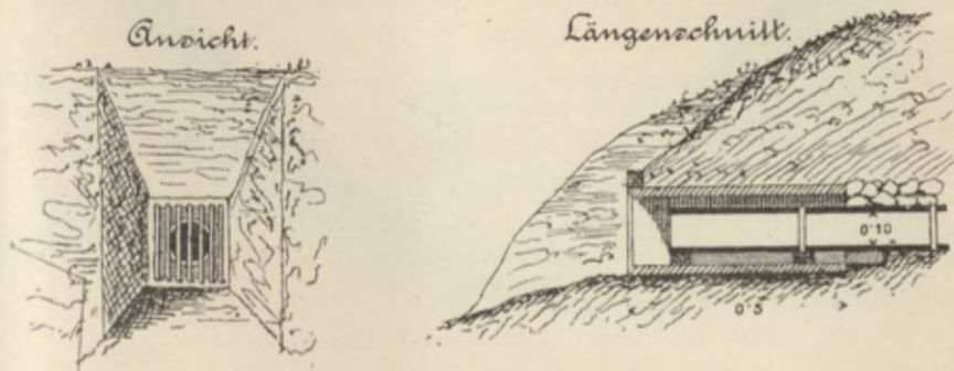
Fig. 326. Drainage-Auslaufobjekt aus Holz.
