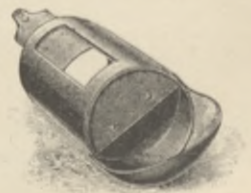
Fig. 18. Universalbohrer, liegend. Universalbohrer für Trieb- und Schlamm.
