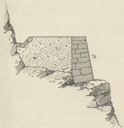
Fig. 178. Futtermauer zur Vermeidung langer Dammböschungen.
