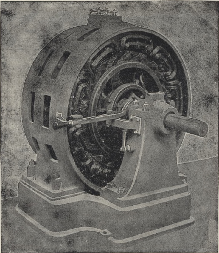
Fig. 232. Hochspannungsmotor (5000 Volt) von Oerlikon.
