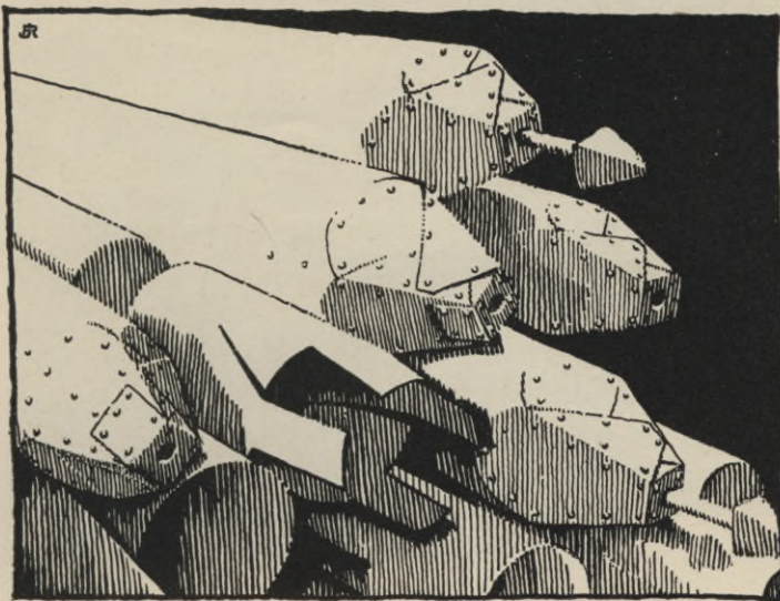
Fig. 6. Rohrspitzen der Pfahlform „System Mast“.
