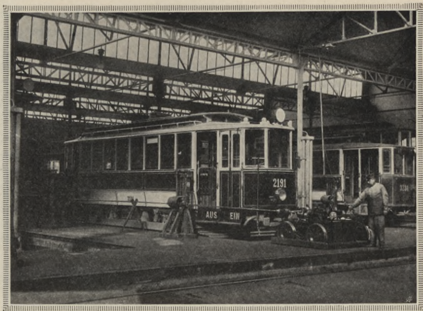
Hochheben eines Wagens durch elektrisch angetriebene Hebeböcke
