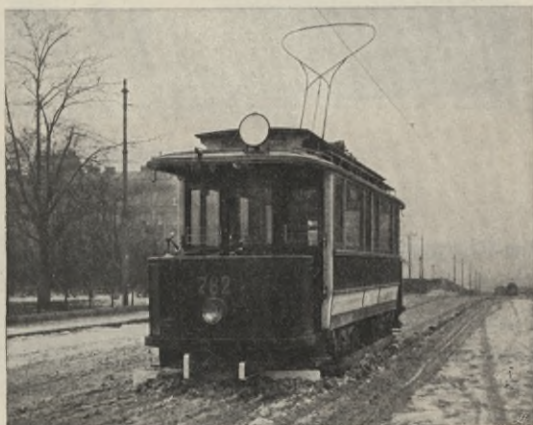
Triebwagen mit dem Schneebrett (Patent)
