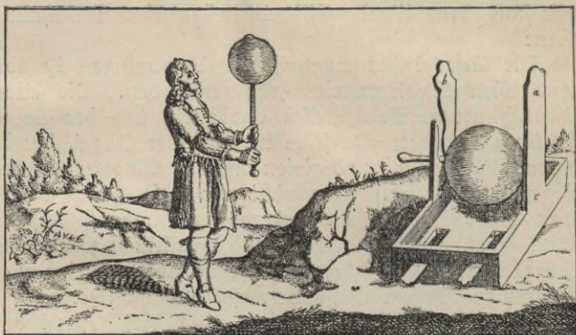
Abb. 1. Die erste Elektrifiziermaschine, erfunden von Guericke.
