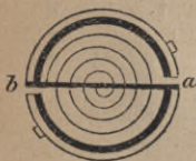
Abb 5. Kompensierte Unruhe einer Taschenuhr.
