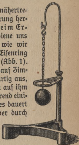
Abb. 1. Ausdehnen beim Erwärmen.
