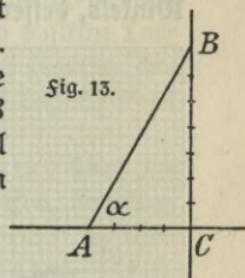
**6. Ermittlung der Werte des Tangens für gegebene Winkel.** Für diejenigen Winkel, für welche die Bestimmung des Sinus leicht möglich war (vgl. § 4, 4), läßt sich auch der Wert des Tangens leicht angeben. So ist für das gleichschenklige rechtwinklige Dreieck (Fig. 5)
