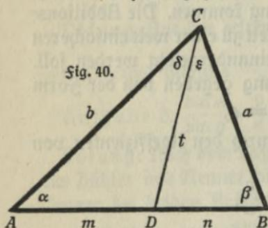
Lösung. (Fig. 40). Im Dreieck  $ADC$  ist nach dem Sinusatz  $\frac{\sin \alpha}{\sin \delta} = \frac{t}{m}$ , im Dreieck  $DBC$  ist  $\frac{\sin \beta}{\sin \varepsilon} = \frac{t}{n}$ . Durch Division findet man aus beiden Gleichungen  $\frac{\sin \alpha}{\sin \beta} = \frac{n \sin \delta}{m \sin \varepsilon}$ . Aus dieser Gleichung kann man wie in A. Aufgabe 3 die Winkel
