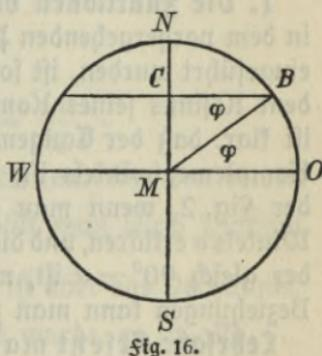
**8. Die Funktionen der Winkel von  $0^{\circ}$  und  $90^{\circ}$ .** Wenn man in dem Dreieck ABC (Fig. 2) die Ecke B auf der Kathete BC immer näher an C heranrückt bis schließlich B mit C zusammenfällt, so wird Winkel  $\alpha$  gleich  $0^{\circ}$ ,  $a = 0$  und die Hypotenuse fällt mit der Kathete  $b$  zusammen. Es wird also  $b = c$ . Bestimmt man für diesen Fall nach den gegebenen Erklärungen die Werte der vier trigonometrischen Funk-
