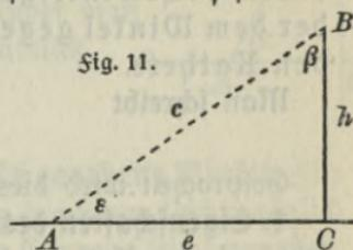
Lösung: (Fig. 11). Da die gegebenen Größen  $e$  und  $\varepsilon$  nicht durch eine Gleichung nach der Erklärung des Sinus miteinander verknüpft werden können, bestimmt man zunächst den Winkel  $ABC = \beta$ . Es ist
