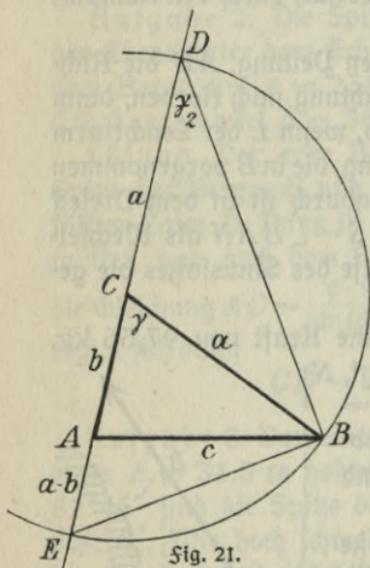
In dem Dreieck  $AEB$  ist Seite  $AB = c$ , Seite  $AE = a - b$ , ferner, da der Winkel  $EBD$  als Peripheriewinkel im Halbkreis gleich einem Rechten ist,  $\angle AEB = 90^\circ - \frac{\gamma}{2}$  als Komplementwinkel zu  $\angle ADB$ , und  $\angle ABE = \frac{\alpha - \beta}{2}$  als Komplementwinkel zu  $\angle ABD$ . Man erhält daher, wenn man den Sinussatz auf das Dreieck  $AEB$  anwendet,
