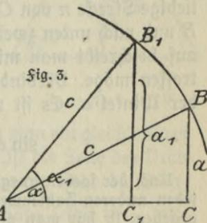
indem man vom Schnittpunkt  $B_1$  seines Schenkels mit dem Kreise die Senkrechte auf  $AC$  fällt, so erkennt man, daß der Sinus eines Winkels sich ändert, wenn der Winkel sich ändert. Es bleibt nämlich in dem Bruche, der den Wert des Sinus angibt, der Nenner ungeändert, während der Zähler stets andere Werte annimmt. In Fig. 3 ist  $\sin \alpha = \frac{a}{c}$  und
