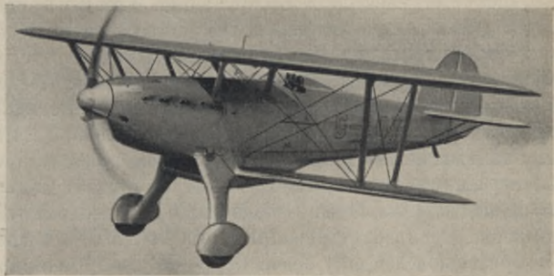
Abb. 18. Englisches Versuchsmuster eines Kanonen-Jagdeinsitzers, Fairy „Fantomé“. Die Bewaffnung besteht aus einer auf dem Motor eingebauten Flugzeugkanone, Kal. 20 mm, und 4 starren MG.
