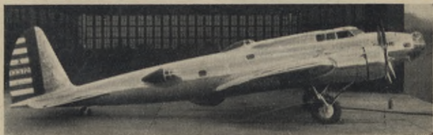
Abb. 12. Der schwere amerikanische Bomber „Boeing 299“, der eine Bombenlast bis zu 4000 kg befördern kann. Beachtenswert ist die starke Bewaffnung, die in 5 geschützten MG.-Ständen untergebracht ist, von denen einer im Rumpfbogen, einer auf Rumpfoberseite über Flügelhinterkante, einer an Rumpfunterseite hinter Flügelhinterkante und je einer beiderseits des Rumpfes zwischen Flügelhinterkante und Leitwerk angeordnet ist.
