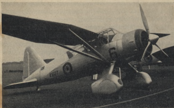
Abb. 1. Das neueste englische Aufklärungsflugzeug der Firma „Westland“. Der Forderung nach guter Sicht ist durch die Wahl der Hochdeckerbauweise und die Ausführung des mit durchsichtigem Werkstoff verkleideten Aufsatzes über Führer- und Beobachterraum Rechnung getragen. Die Ausrüstung mit Landeklappen an der Flügelhinterkante und selbsttätigen „Handley-Page“-Spaltflügeln, die fast über die gesamte Flügelvorderkante reichen, gewährleistet die geforderte große Differenz zwischen Höchst- und Mindestgeschwindigkeit.
