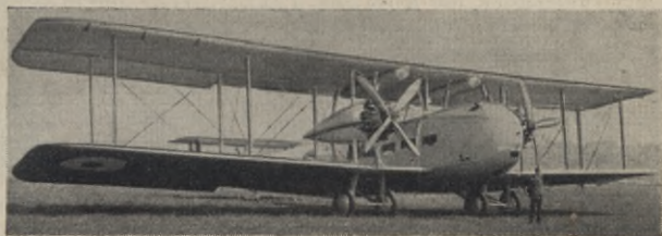
Abb. 6. Englischcs Truppentransportflugzeug Vickers „Valentia“ zur Beförderung von 18 Mann mit voller Ausrüstung.
