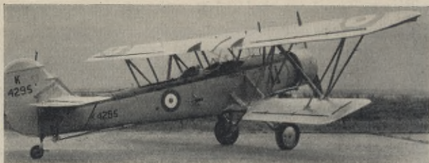
Abb. 26. Das bei der englischen Luftwaffe für den Einsatz von Flugzeugträgern aus verwendete Torpedoflugzeug Blackburn „Shark“. Man erkennt deutlich den hochziehbaren Haltehaken am Rumpffende (vor dem Spornrad).
