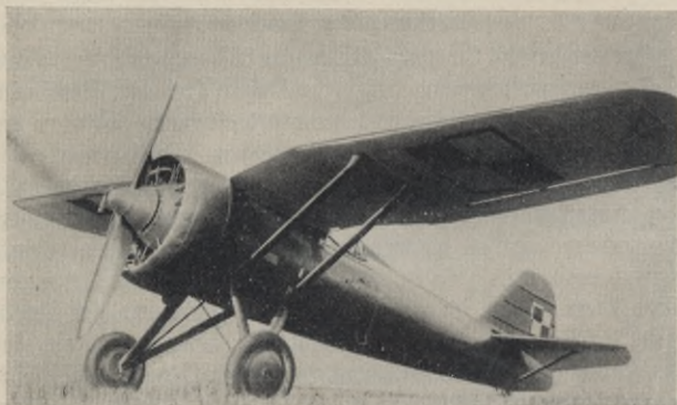
Abb. 29. Hochdecker mit Knickflügel (polnischer PZL-Jagdeinsitzer). Vom Führersitz aus besteht Sicht über den mittleren, nach unten geknickten Flügelteil hinweg und unter den Flügel hindurch.
