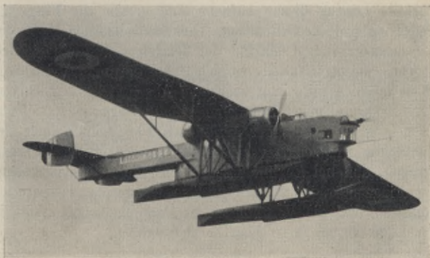
Abb. 27. Das französische Bomben-Seeflugzeug „Latécoère 55-0“. Die Bewaffnung ist in 3 Gefechtsständen untergebracht, die im Rumpfbug, auf Rumpfoberseite hinter Flügelhinterkante und im rückwärtigen Teil des unteren Rumpfstockwerks angeordnet sind.
