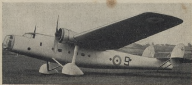
Abb. 7. Englischer Bomber-Transporter „Bristol 130“. Beim Einsatz vom Truppentransportflugzeug können 24 Mann mit voller Ausrüstung, beim Einsatz als schwerer Bomber etwa 2000 kg Bombenlast befördert werden.
