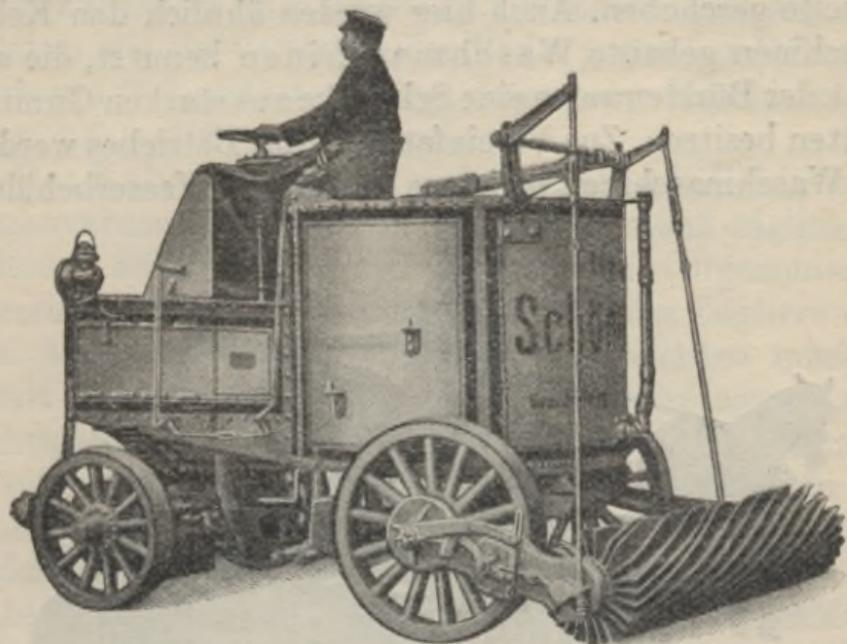
Abb. 50. Waschmaschine mit Sprengvorrichtung.
