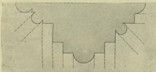
Fig. 219. Schema des entwickelten romanischen Pfeilers.
