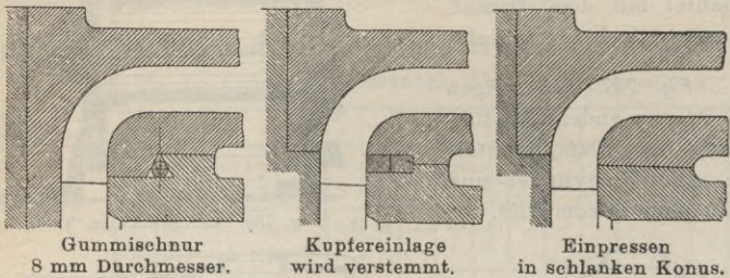
Fig. 740—742. Dichtungsmethoden der Einsatzcylinder.
