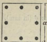
$a = 15 \text{ cm}$ ,8 Eisen vom Durchmesser  $\delta$  (in mm), $g = 54 \text{ kg/m}$ .
