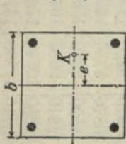
$b = 25 \text{ cm}$ ,4 Eiseneinlagen vom Durchmesser  $\delta$  (in mm), $K = \text{Angriffspunkt der Kraft},$  $g = 150 \text{ kg/m}.$
