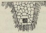
Fig. 33. Sickerschlitz.
