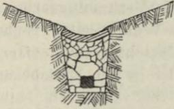
Fig. 32. Sickerschlitz mit Schale.
