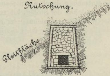
Fig. 29. Querschnitt des Entwässerungstollens.
