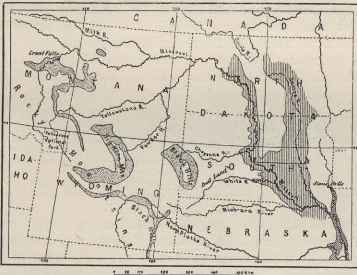
Fig. 157. Oberflächenverbreitung des Dakota-Sandsteins in den Rocky Mountains (punktiert) und positiv piëzometrisches Gebiet in Dakota (vertikal schraffiert)
