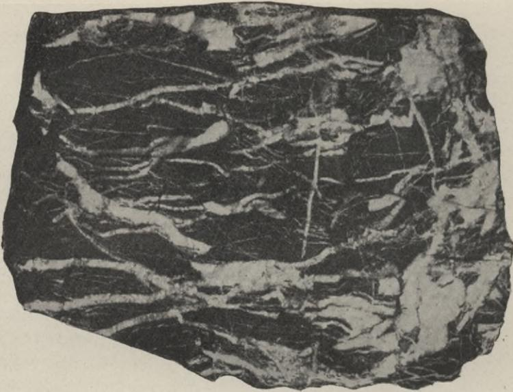
Fig. 30. Stark durchtrümelter Kieselschiefer, die Risse sind durch Quarz wieder verheilt
