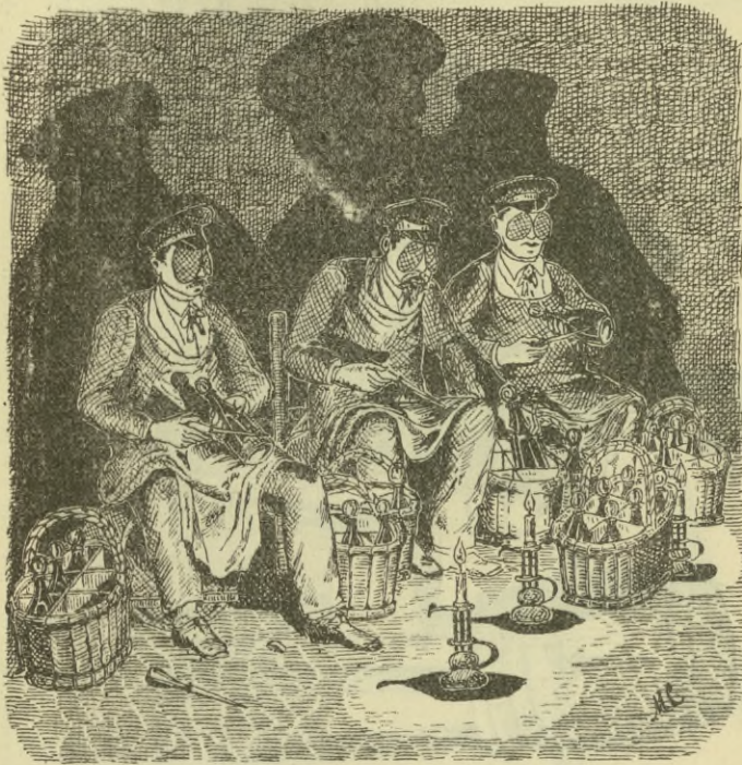
Fig. 153. — Enlèvement du « masque » ou dépôt adhérent, par chocs produits à l'aide d'une baguette de fer. Ces chocs occasionnent parfois des explosions ; les ouvriers doivent se protéger la figure avec des toiles métalliques.
