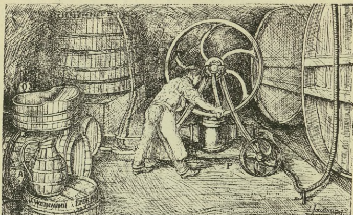
Fig. 132. — Soutirage à la pompe à l'abri de l'air.
