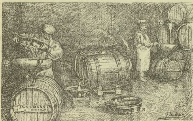
Fig. 136. — Soutirage au contact de l'air.
