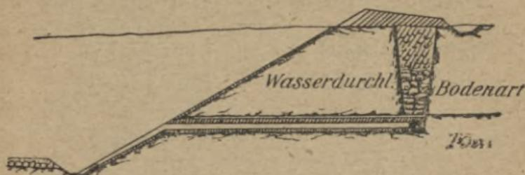
Abb. 67. Vorbeugung gegen Böschungsrutschung durch Wasserableitung in Höhe der Tonschicht.
