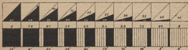
Abb. 6. Schraffierungsverhältnis der Böschungen.
