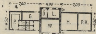
Fig. 28. M. = 1:500. Nebengebäude. P. Pissoir. L. Lampenraum. G. Geschirraum. W. Waschküche. H. Holzlege. P.K. Postkarren.
