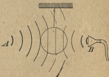
Fig. 32. Brechung der Schallwellen durch eine mit Kohlensäure gefüllte Kollodiumkugel.
